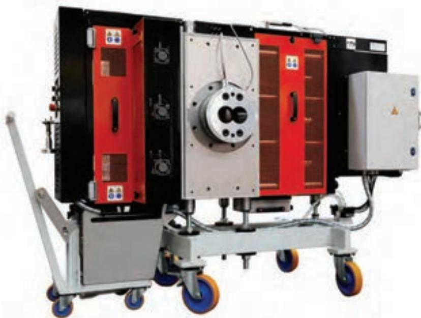
tipo di tessitura utilizzata per gli elementi filtranti, i cicli di lavaggio eseguibili prima della sostituzione delle reti filtranti variano da alcune decine fino a più di duecento.
