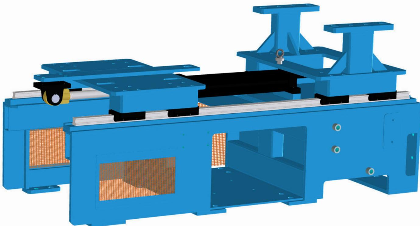
Il modello tridimensionale si riferisce ad un progetto personalizzato in base alle esigenze del cliente finale. Questo tipo di progettazione garantisce la massima precisione nel calcolo degli ingombri ed un perfetto accoppiamento in fase di installazione.
