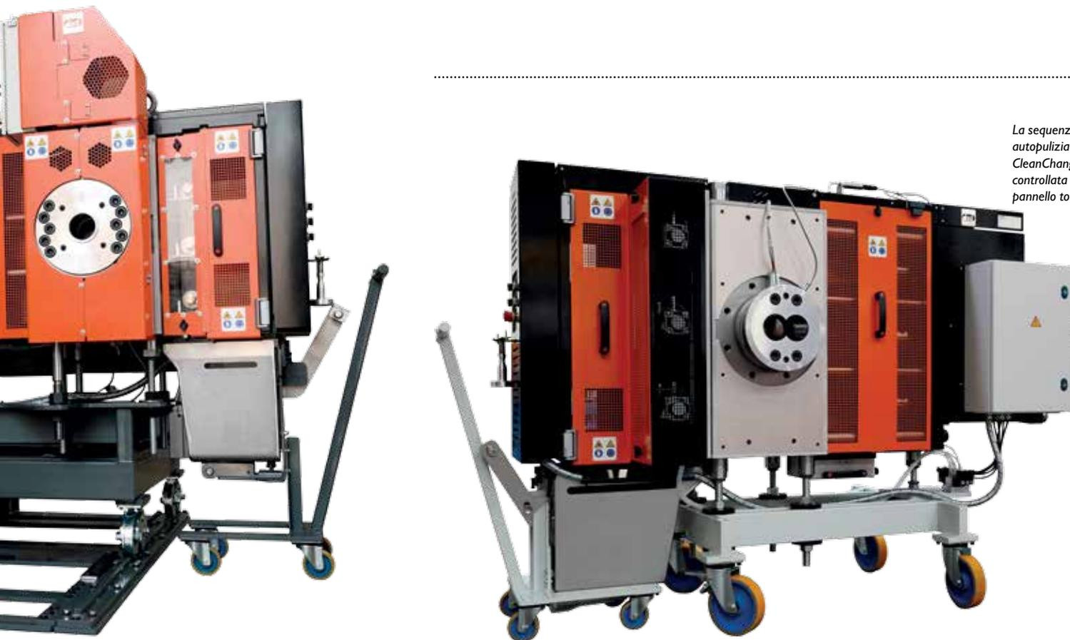
La sequenza di autopulizia di CleanChanger® è controllata da PLC con pannello touch screen
