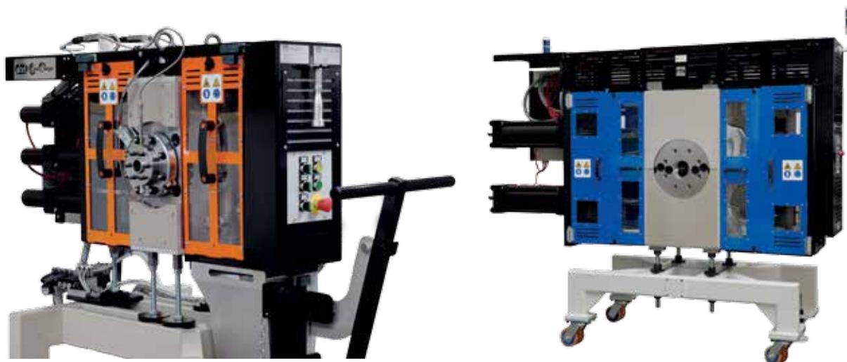
il cambiafiltri, infatti, è un elemento determinante in una linea di riciclo ed è capace di condizionare la qualità del polimero ottenuto e quindi la redditività del processo produttivo. L'integrazione del cambiafiltri nella linea di estrusione permette di ottenere un materiale privo di impurità, conforme ai requisiti di utilizzo più stringenti ed economicamente conveniente.
